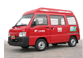
ガソリン車の改造電気自動車
